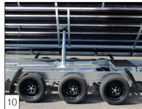
**De série :** les modèles avec 2- et 3 essieux ont des essieux lames de ressorts paraboliques avec amortisseurs et pneus 195/50 R13 avec jantes noires.
