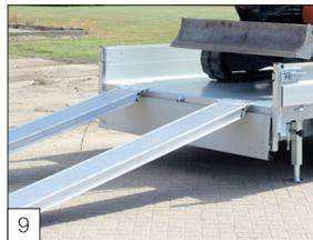
**Option :** avec pack „DE CHARGE“: 2 rampes en aluminium de 250 cm intégrés, 2 béquilles réglables et manivelle.
