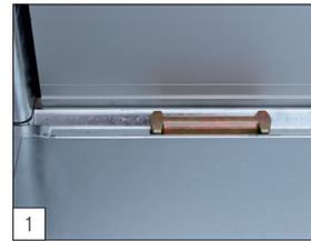
**De série :** système d'arrimage de chargement HAPERT certifié par TÜV: anneaux d'arrimage intégrés dans les côtés.
