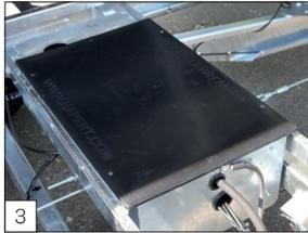
**De série :** pompe électrique avec batterie située dans une caisse en acier galvanisée, recouverte d'un couvercle plastique.
