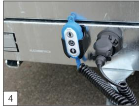
**De série :** caisse de commande amovible avec câble en spirale allongé.
